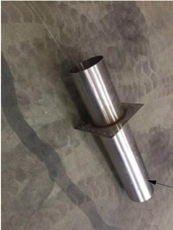
梯度波导安装示意图
